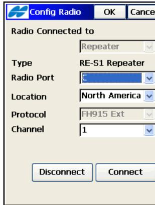
Abbildung 8-9. Konfigurieren des RE-S1 als Repeater
