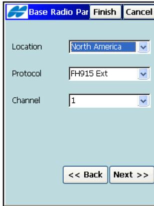
Abbildung 4-13. Parameter für FH915+Modems
