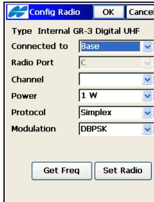
Abbildung 8-8. Konfigurieren eines GR-3-UHF-Digitalfunkgeräts
